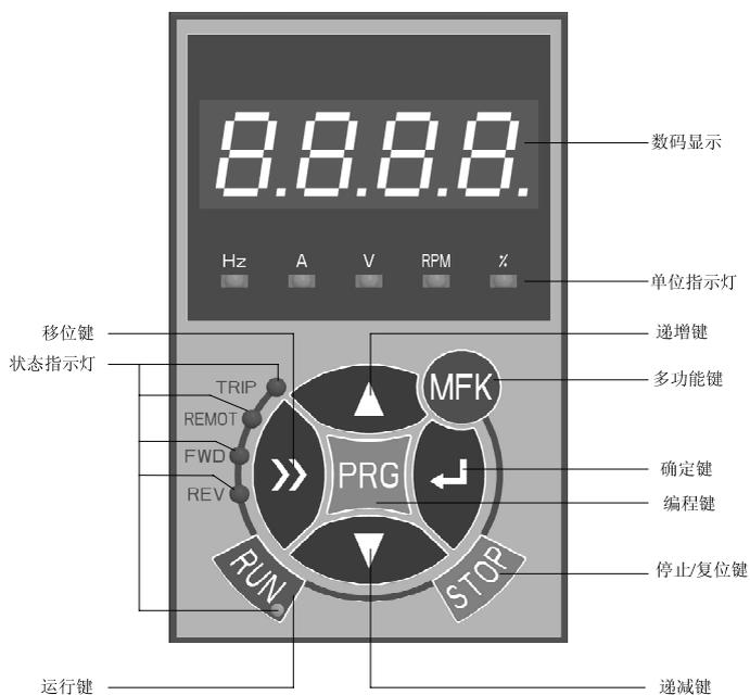
图 4-1 操作面板示意图
